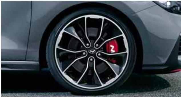
Die sportlichen 19-Zoll Leichtmetallfelgen mit den rot lackierten Bremssätteln mit N-Logo wurden speziell auf den Charakter der N-Modelle abgestimmt.
