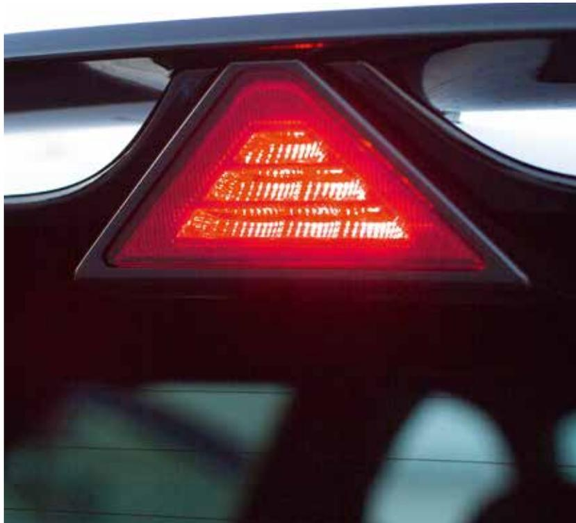
Der schwarz glänzende Heckspoiler verfügt über ein integriertes dreieckiges Bremslicht, das beim i30 N für eine verbesserte Aerodynamik und eine bessere Sichtbarkeit sorgt.
