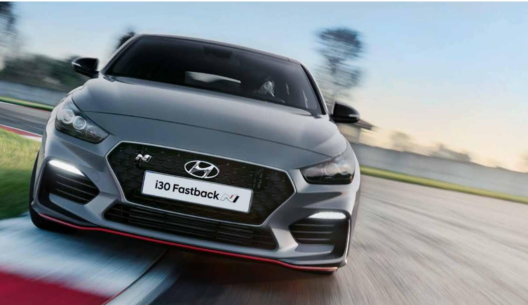
Der i30 Fastback N verfügt über Voll-LED-Scheinwerfer und Tagfahrlicht für hervorragende Sicht und markante Optik. Die aggressiv großen Lufteinlässe wurden entwickelt, um die Bremskühlung und die Aerodynamik zu verbessern.
